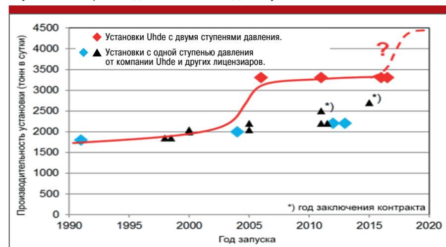
Рис. 1. Сводная информация по крупным установкам аммиака с указанием производительности и года запуска.
