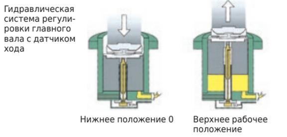
Гидравлическая система регулировки главного вала с датчиком хода
