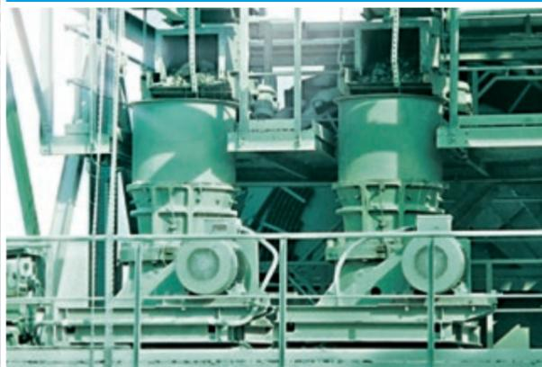
Две конусные дробилки Kubria® (диаметр конуса 750 мм) на заводе по производству шпал
